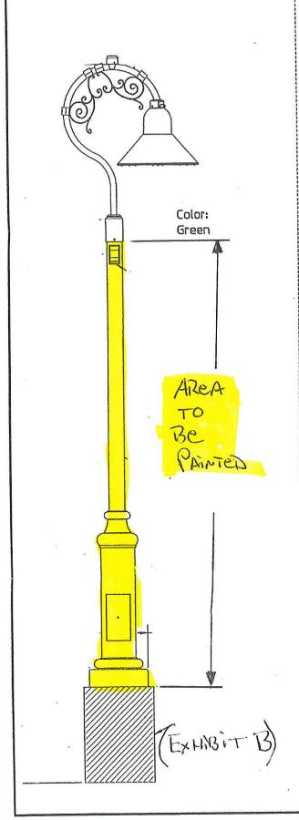
Luminaire Detail Scale 1:16
